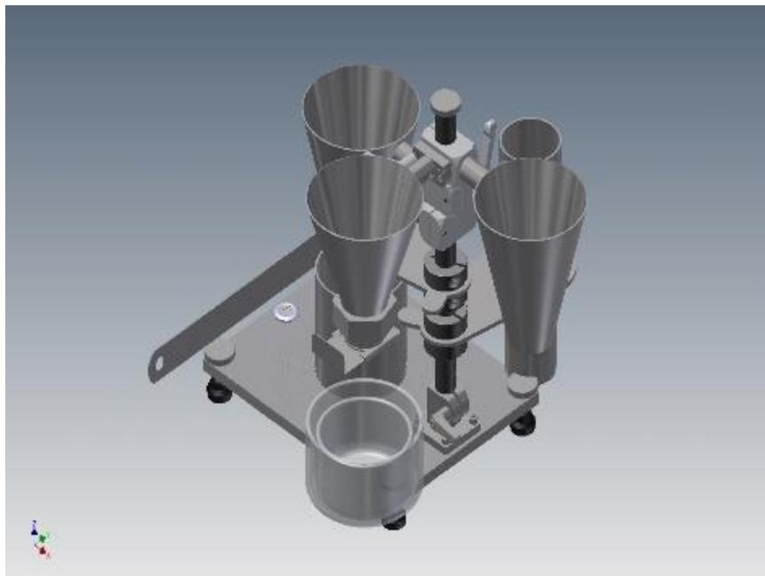
Bildunterschrift 4: Das Prüfgerät für die Ermittlung der Schüttdichte und der Rieselfähigkeit von Granulaten von Stefan Uhlmann.
